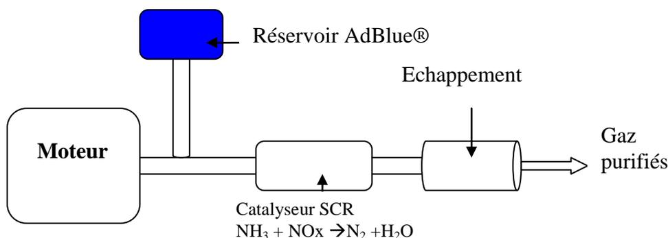
Si le véhicule fonctionne sans AdBlue®, le catalyseur sera irrémédiablement endommagé, en effet l'oxyde d'azote bouche les pores du catalyseur provoquant une perte de puissance du moteur et des gaz émis hors normes en ce qui concerne les polluants azotés.
