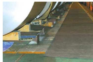
Le polypropylène aiguilleté rend le produit résistant aux déchirures et présente une haute résistance à l'abrasion. Résiste aux passages de véhicules et de chariots élévateurs.
